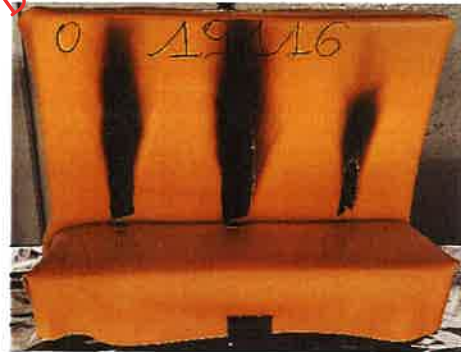
Il terzo innesco sulla provetta campione 2
