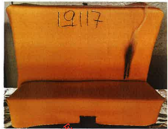
il primo innesco sulla provetta the first ignition
